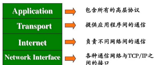
图5 TCP/IP体系结构
